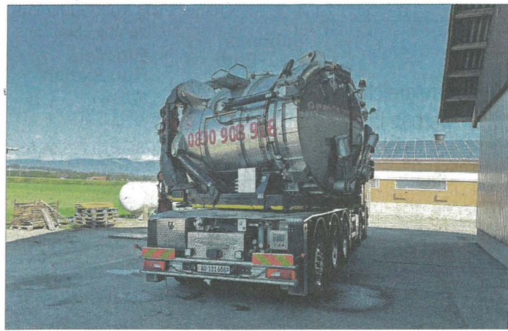
Der Saugbehälter hat ein Fassungsvermögen von acht Kubik Festmaterial und verfügt über eine Hochkippeinrichtung.
